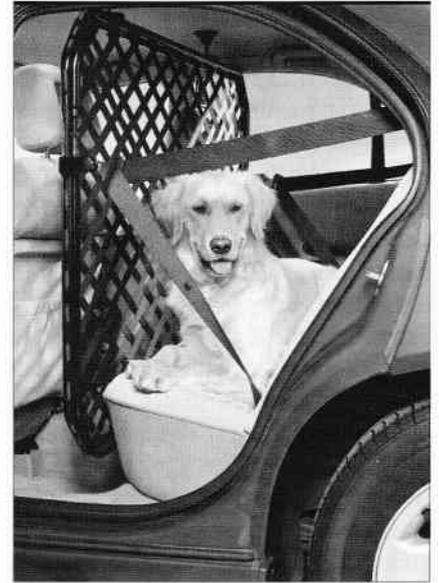
**Abb. 10** Trenngitter für den Fahrzeuginnenraum (Fa. Kleinmetall)
