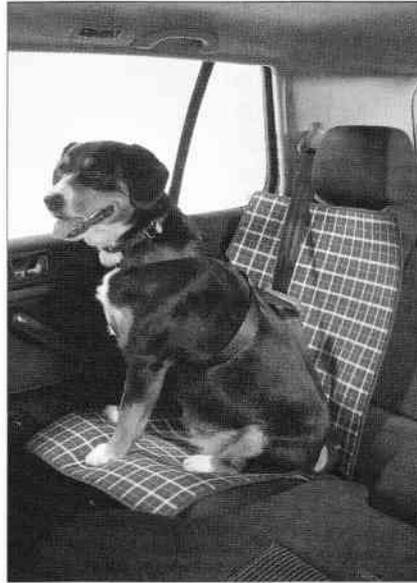
**Abb. 9** Tiersicherheitsgurt (bis 20 kg Körpermasse; Fa. EHV)
